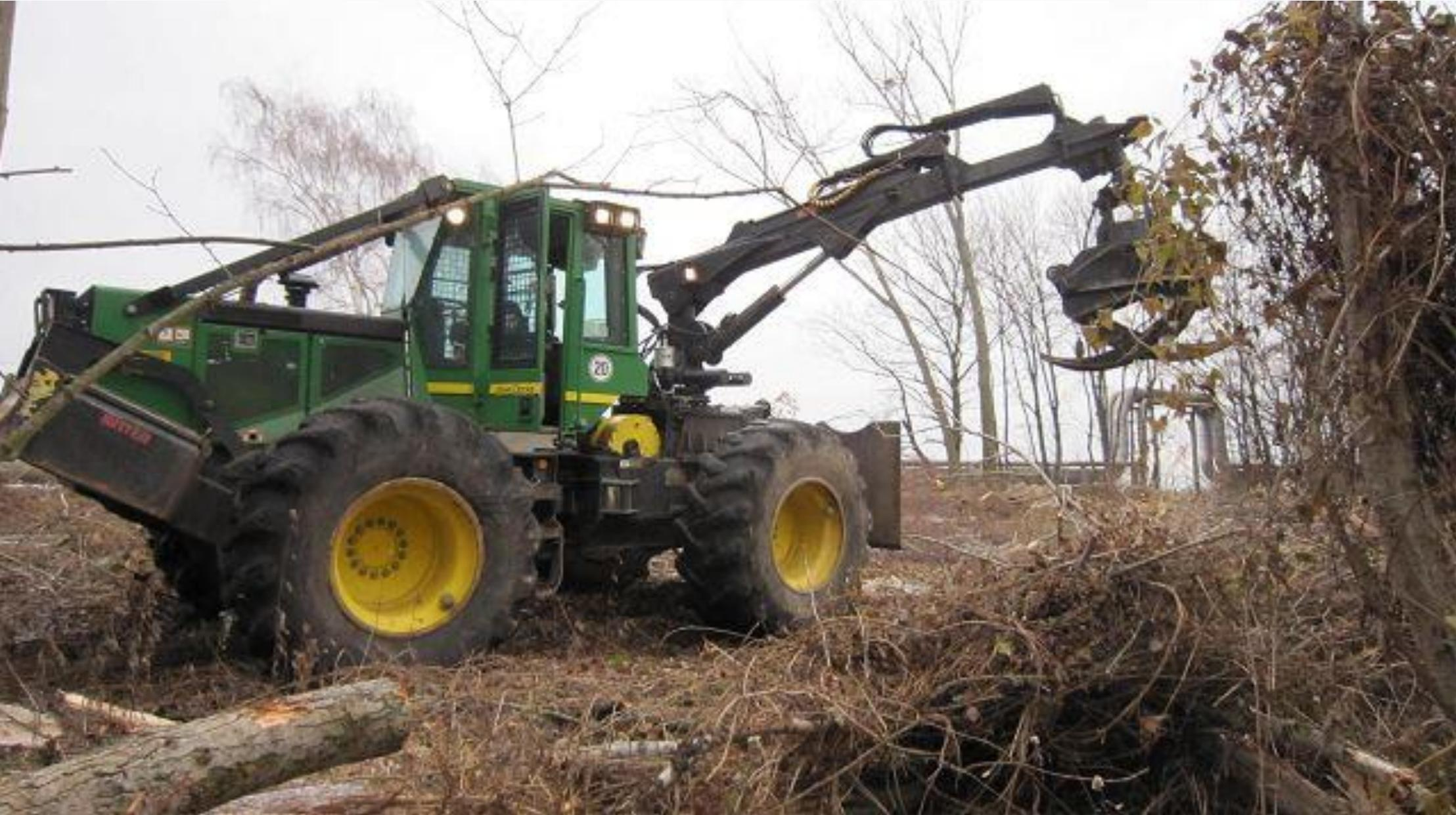
Zum Einsatz kamen ein Harvester (Vollernter), ein Skidder (Seilschlepper), und ein Forwarder (Rückezug).
