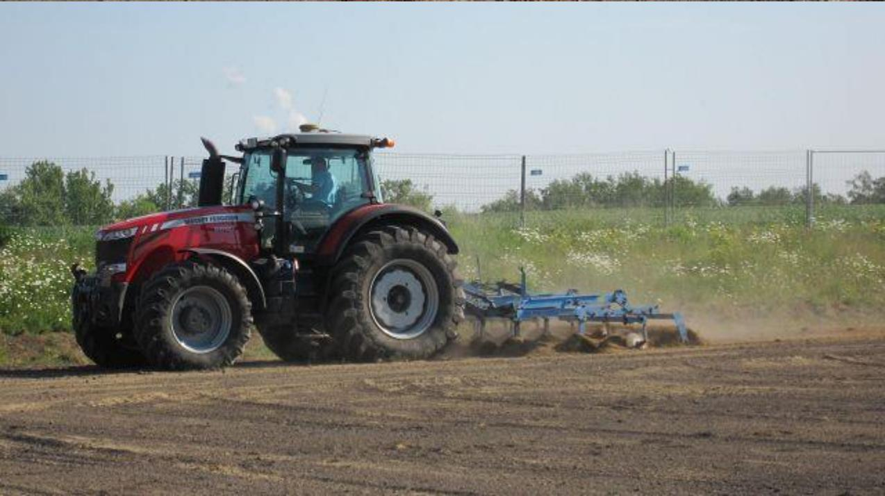
**Mittels zweier verschiedenen Eggen (grob und fein) werden die 3 Schichten bestehend aus Humus, Mutterboden und Sand vermischt.**
